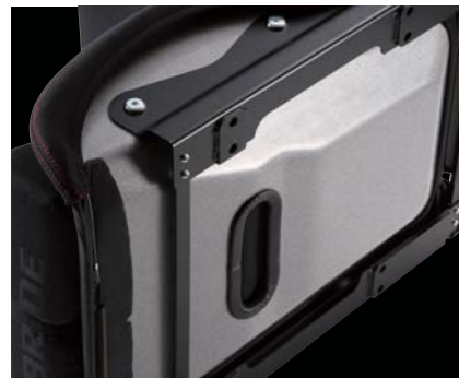
座面には、モータースポーツとサーキット走行に必要な6点式ハーネス用のホールが新設されている。
