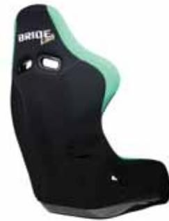
ZETAⅢは背面までフルカバーすることにより、後部座席乗員保護のためのシートバックプロテクター（後付け）を装着せず、そのまま車検対応としています。
