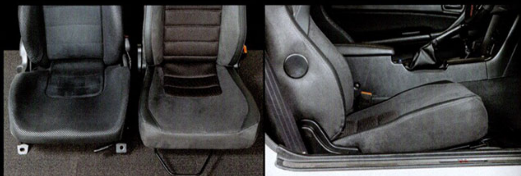
座面部は面で支えるようにサポートしてくれるような形状。そのため純正よりもフラットなタイプとなるがホールド性に不安はない。サイド部が低くなったことで乗降性も高まり、乗り降りの連続でサイドがへたってしまうようなことも抑えられるのはうれしい
