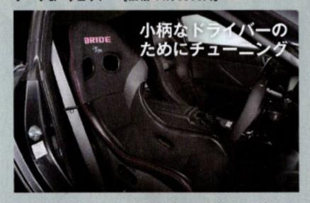
ZETAIVよりもサイドサポートを約30mm狭く、 着座高を約15mm (脱着式のウレタン内蔵で約30mm へ調整可能)高くチューニング。身長160cm以下 の小柄でスリムなドライバー向けのモデルだ。
