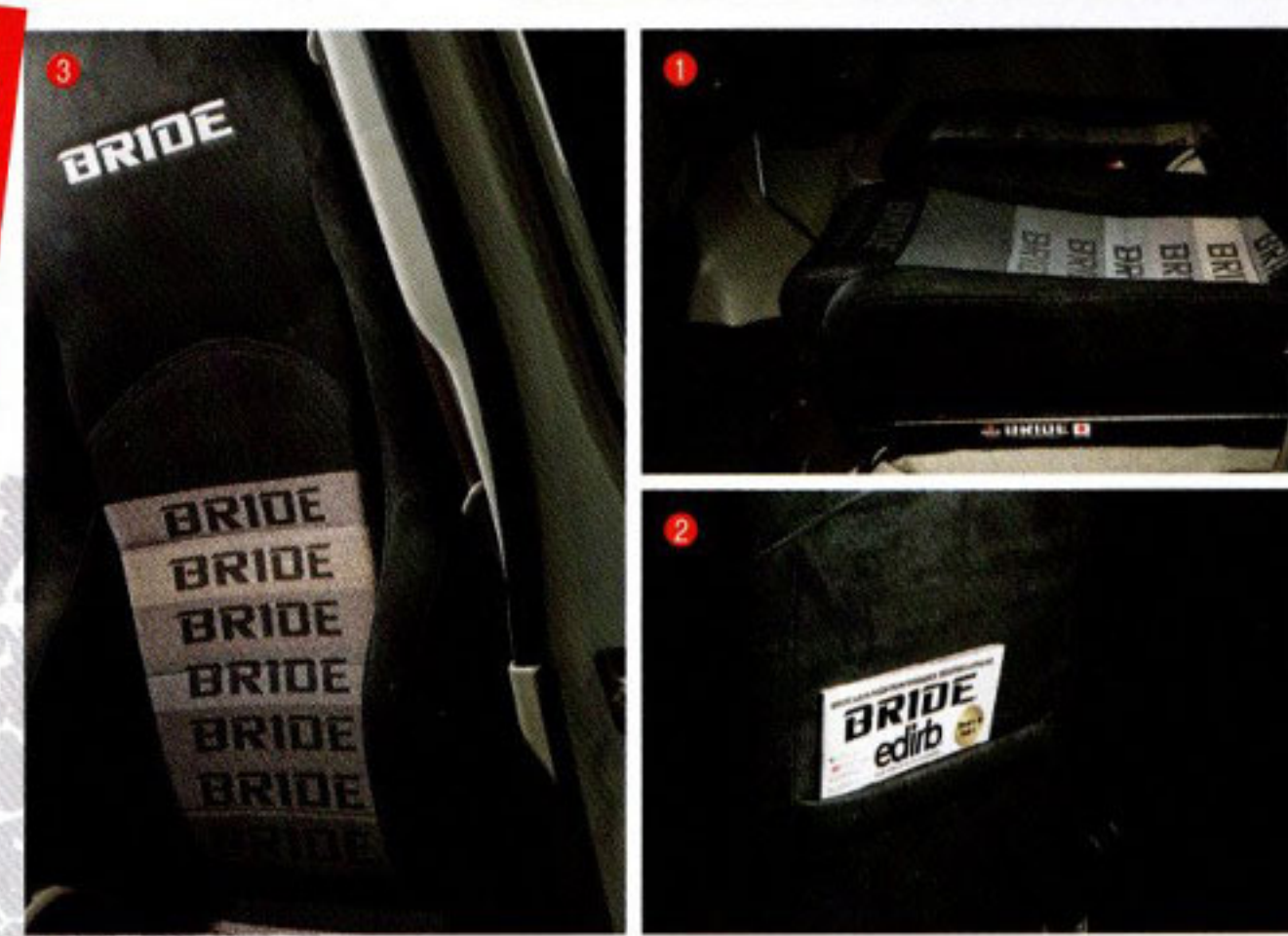
①クッションウレタンの硬度を調整して座面を極限まで薄くした設計。DA17系エブリイの場合、純正シートと同等の着座位置となるので、乗降する際も脚が引っかかることはない。②背面にはシートポケットが備えられ、雑誌やタブレットなどを収納できる。③背もたれは緩やかに寝るストレート形状で、リラックスしたシートポジションが可能。脇下から腰にかけてサポートしてくれるので、運転がラク!
