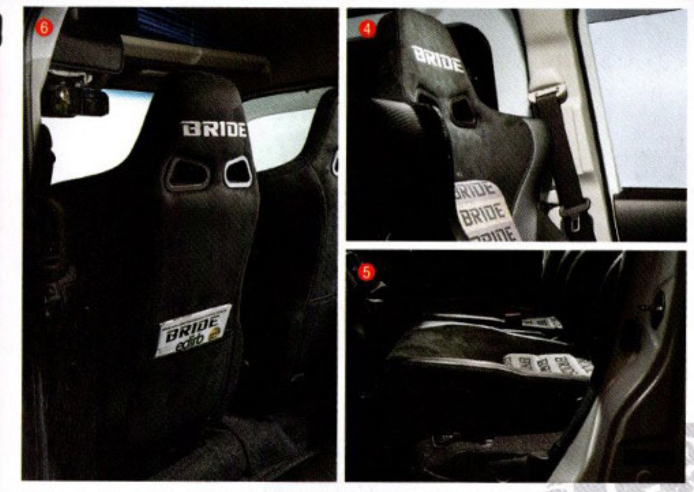
④ショルダーサポート部の駄肉を削り込み、エラが張ったような斬新なデザイン。500mmというショルダー幅を実現し、室内幅の狭い軽バンでもBピラーに干渉することはない。⑤ディーゴIIIより10mmほど厚みのあるフラットな座面設計。S700系ハイセットカーゴでは、純正シートより着座位置が約20mmアップとなる。⑥大型ポケットを備えるバックレストは厚みを抑え、後席の居住性を損なわない。
