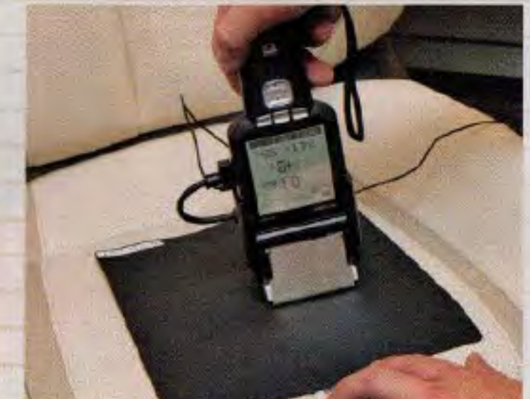
導電性の実験。1000Vの帯電体を近づけると、0.1秒でわずか8Vに。このカブロンSTを設置しないと、100Vに降下するまでに20秒以上かかってしまう。
