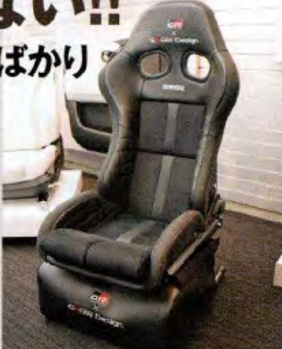
GR TOYOTA Gazoo Racing X GROW Design エアロスタビライジングスポーツシートは導電性表皮材を内蔵した初の市販シート。また、オプション品としてブリッドでも導電性表皮材の設定を予定している。
