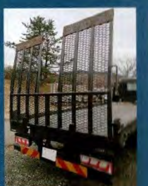
リヤのアオリは油圧作動。サイドのアオリも開くように製作されていた。
