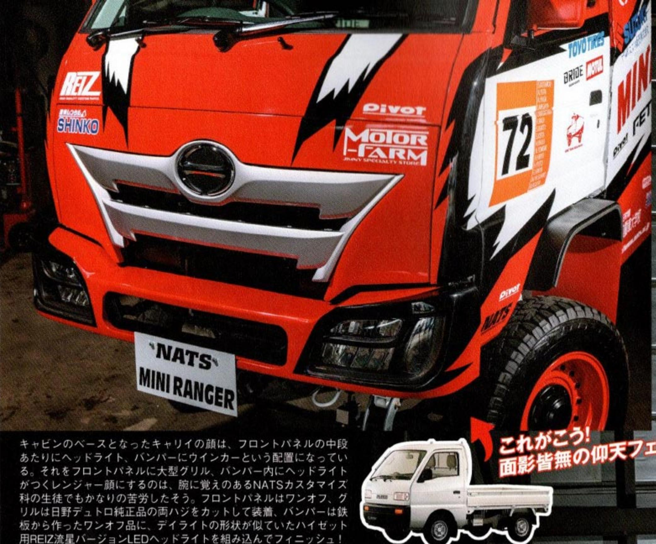
キャビンのベースとなったキャリイの顔は、フロントパネルの中段あたりにヘッドライト、バンパーにウインカーという配置になっている。それをフロントパネルに大型グリル、バンパー内にヘッドライトがつくレンジャー顔にするのは、腕に覚えのあるNATSカスタマイズ科の生徒でもかなりの苦労したそう。フロントパネルはワンオフ、グリルは日野デュロ純正品の両ハジをカットして装着、バンパーは鉄板から作ったワンオフ品に、デイライトの形状が似ていたハイゼット用REIZ流星バージョンLEDヘッドライトを組み込んでフィニッシュ!
