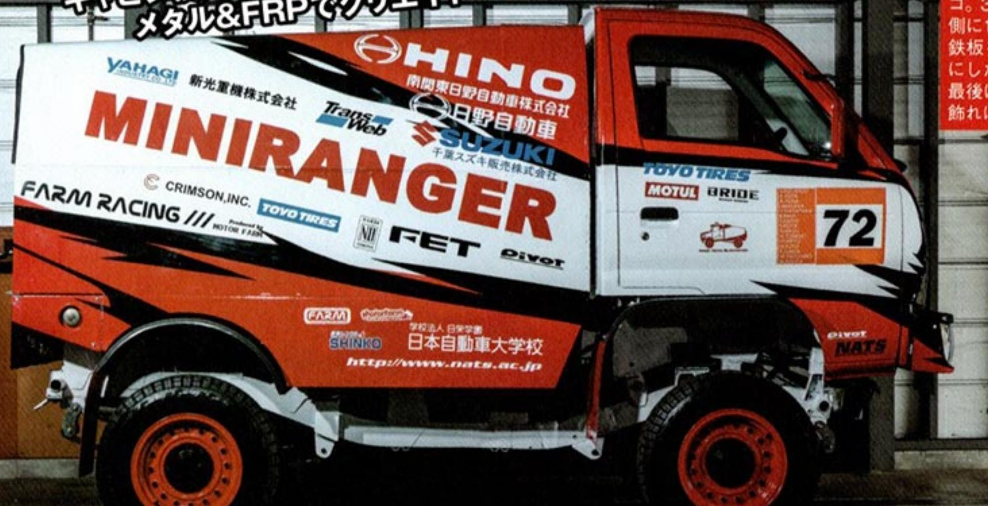
レンジャーらしさを高めてくれる荷台のハコ。30mm角の鉄パイプで骨組みしたあと、上側に1mm厚のアルミ板を6枚、下側に2mm厚の鉄板を4枚貼って作られている。下側を鉄板にしたのは、重心を下げるためだったとか。最後に内側を青のプラス板とアルミと縫合板で飾れば、もはやダカールクオリティ♥
