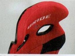
万が一の際にドライバーの頭部を保護するヘッ ドガードを装備しているが、XERO VSならタイト なロードスターにも装着可能。シェル形状はもち ろん、シート表皮などもゼロから新開発されてい るのだ。
