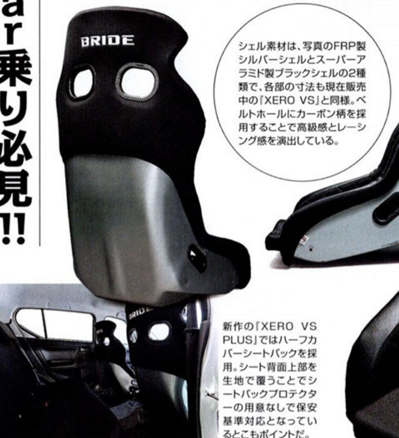
新作の「XERO VS PLUS」ではハーフカバーシートバックを採用。シート背面上部を生地で覆うことでシートバックプロテクターの用意なしで保安基準対応となってい
