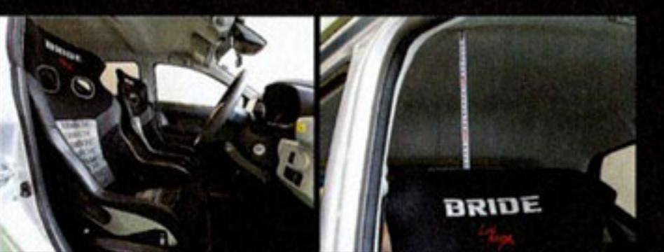
試作品の「XERO VS PLUS」と新作スーパーシートレールを装着した状態。シート上部からルーフまでの距離は約26mmあり、ヘッドクリアランスもかなり広くなるので、平均的な身長のドライバーならヘルメットを被ってもじゅうぶん余裕あるだろう。座面が下がることで重心がさがり、ロールも感じにくくなるためスポーツ走行でも力を發揮してくれる。
