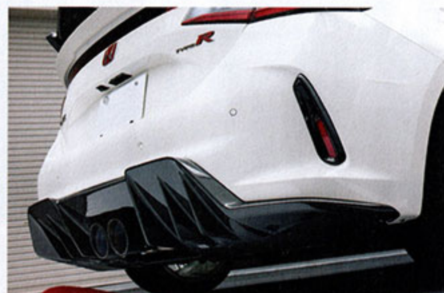
土屋流のパーツチョイスでは「軽さ」も重要で、マフラーはチタン素材のフジツボ製とした。
