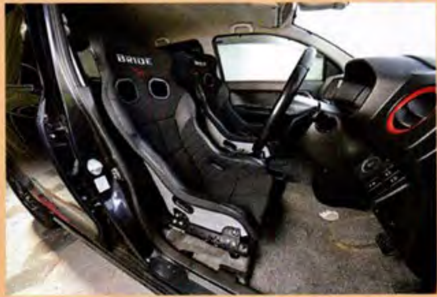
装着例(使用レール: FG) ポジション高 ノーマル比 約-60mm
