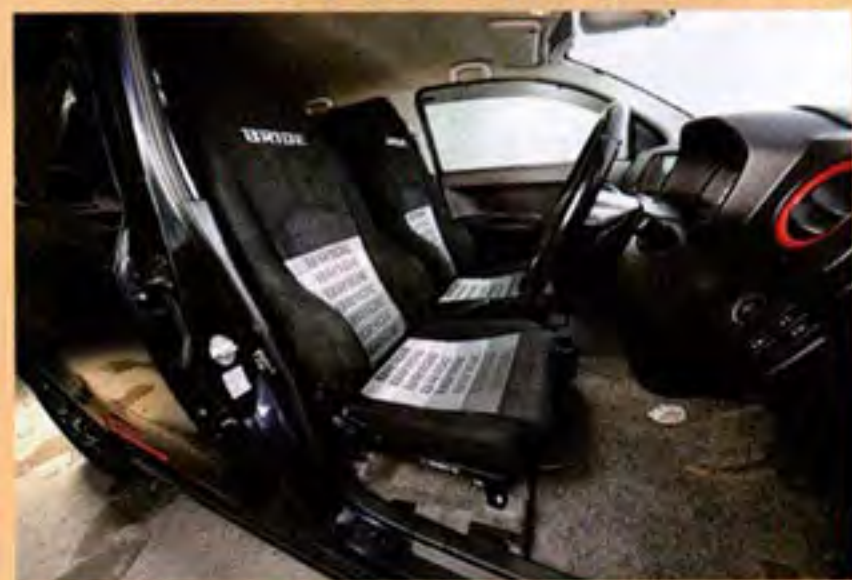
装着例(使用レール: MO) ポジション高 ノーマル比 約-10mm
