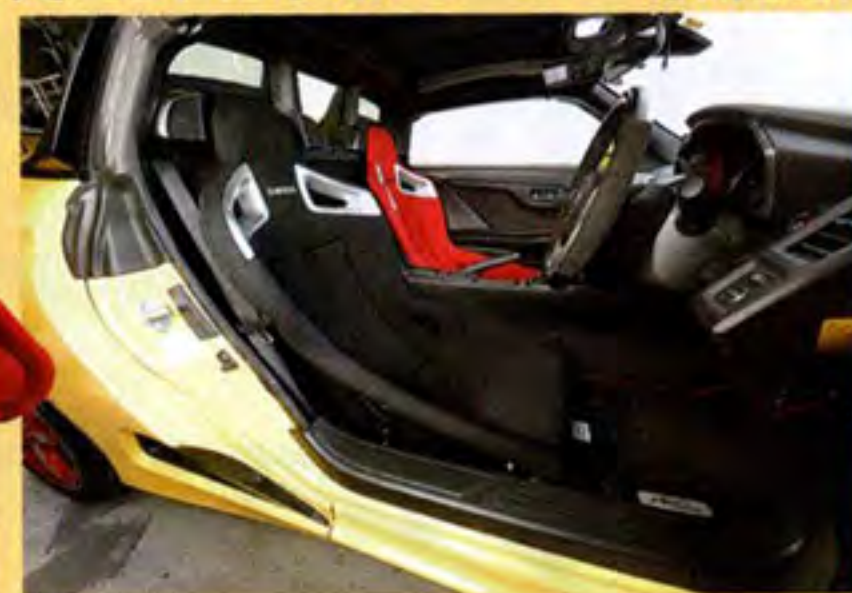
装着例(使用レール: LF) ポジション高 ノーマル比 約-30mm
