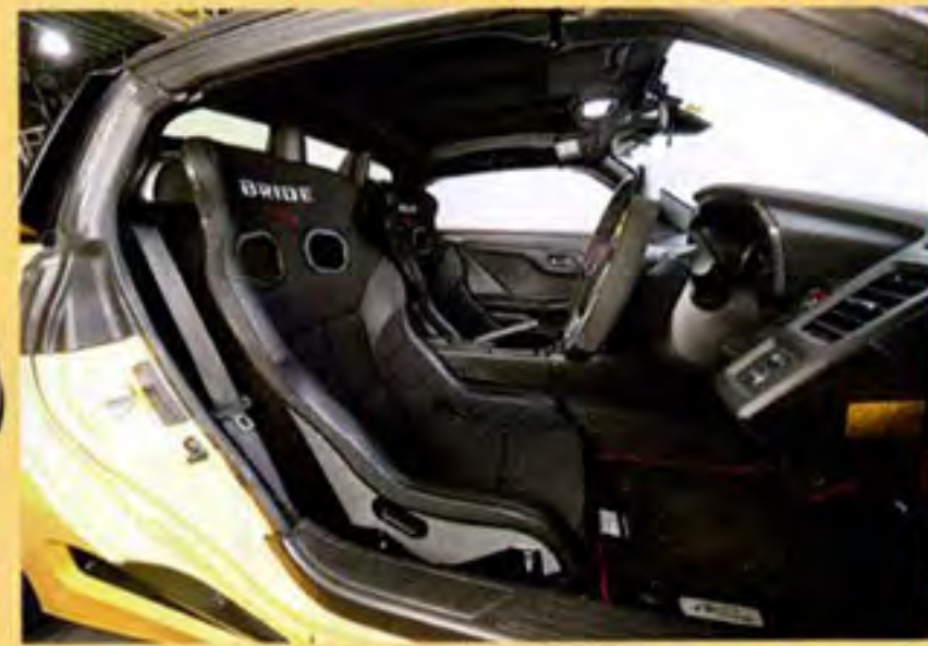
装着例(使用レール: LF) ポジション高 ノーマル比 約-30mm
