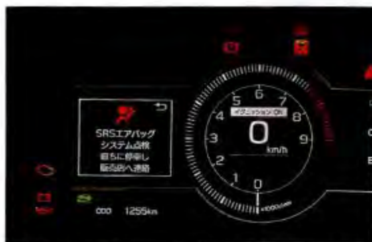
助手席用メモリーマネジメントユニットの装着をせずに助手席シートを交換するとメーターパネルにこのような警告が表示されたりする。走行すること自体は可能だが、この状態では車検に合格することはできない。
