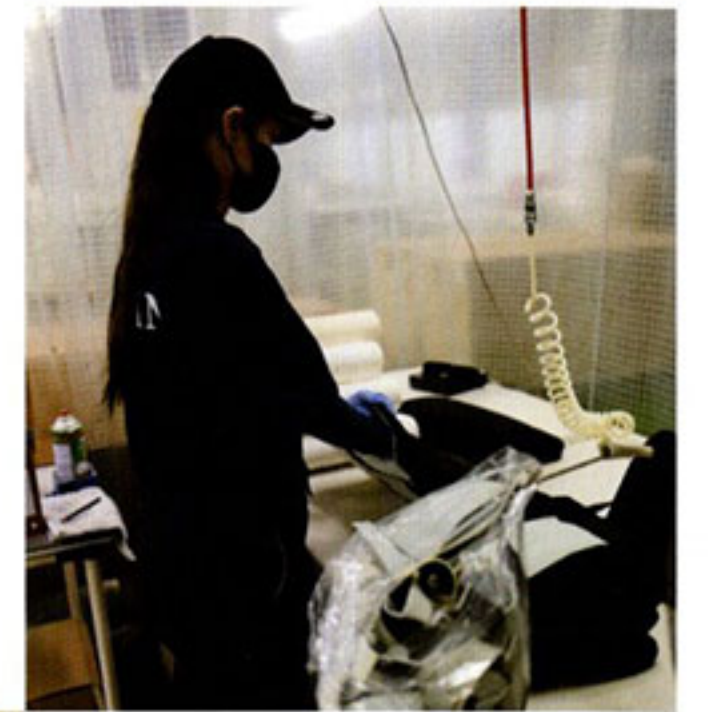
□ フルバケット表皮 縫製が完了した表皮を被せていく。同時にシートクッションも表皮を被せて組み合わせればフルバケットは完成。
