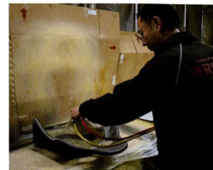
□ リクライニングボンド吹き付け リクライニングシートのストラディアIIIの組み立ては背面と座面に分かれて作業を行う。使用するボンドは耐熱性に優れたものを使用。
