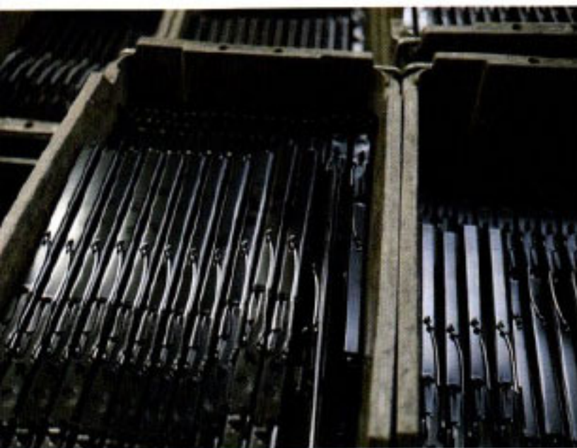
□ スライダー シートレールの肝となるスライダーはスウェーデン鋼を使用するフランスのフォルシア社製を取り寄せている。
