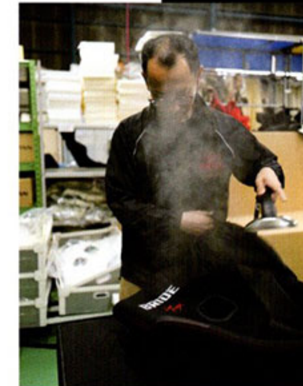
□ スチーム 細かいシワが残ってしまう場合はシワ部分にスチームを当てて伸ばせば完成。あとは座面とともにリクライニングデバイスを組み付ければ完了。
