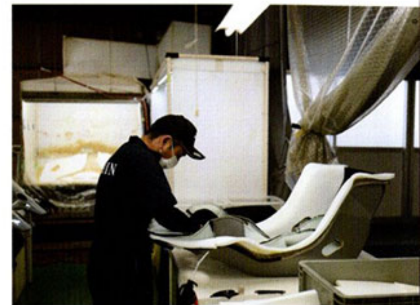
□ フルバケットウレタン貼り 作業されるのはフルバケットモデルのジータIV。ウレタンは背面やショルダー、サイドサポートなどに貼られていく。
