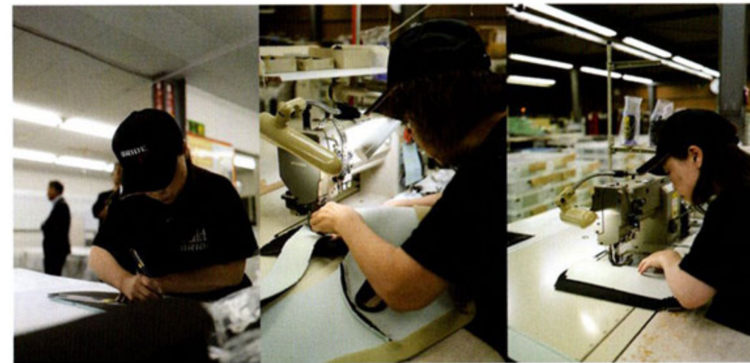
□ 縫製 長い人になると40年以上も縫い子として働くベテランが揃う縫製。もちろんミシンも素材の厚みやステッチに応じて使い分けが行われる。
