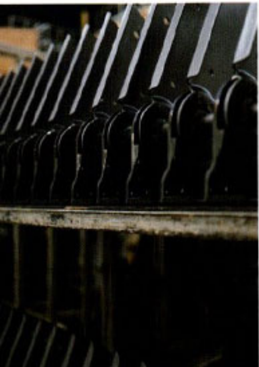
□ リクライニング機構 シートレール部門ではシートレールとともにストラディアなどのリクライニングデバイスの生産も行っている。
