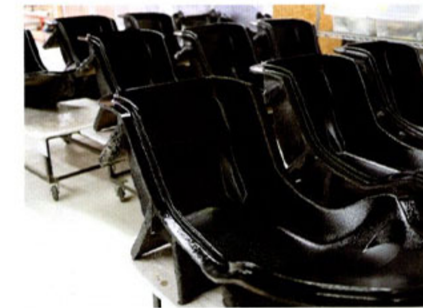
□ ゲルコート 現在使用されるゲルコートはカーボンシェル用のクリアと、車内に合わせやすいガンメタが使われる。
