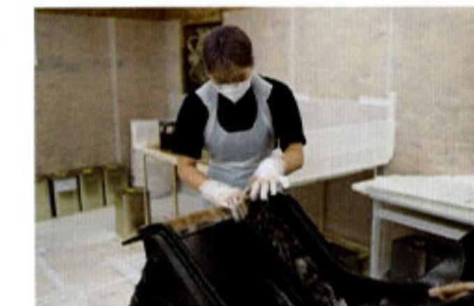
□ ゲルコート 現在使用されるゲルコートはカーボンシェル用のクリアと、車内に合わせやすいガンメタが使われる。
