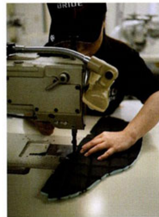
□ ケガキとキルティング エディブルシリーズで 사용되는プロテインレザーのキルティング柄は、ひとつひとつミシンによって作られる。正確なピッチの縫い目は強度と美しさを表現している。
