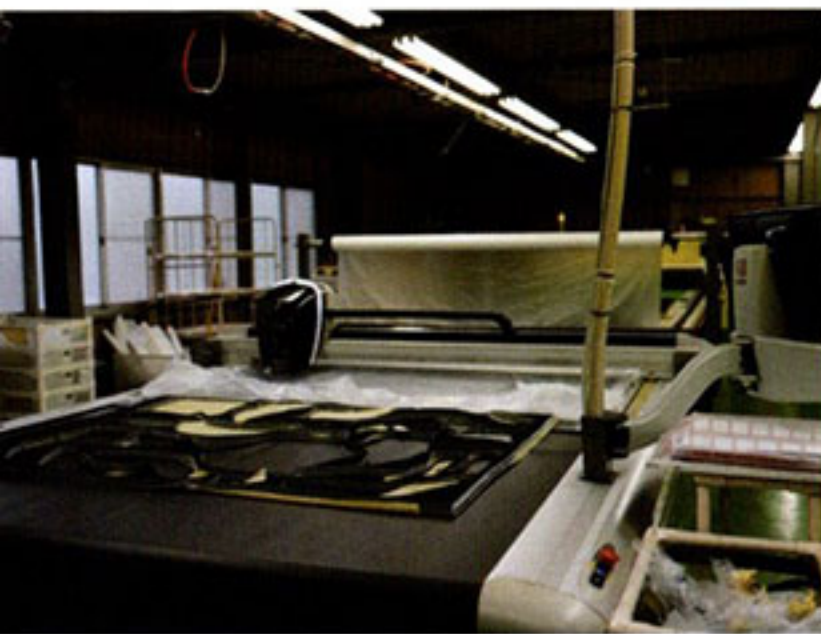
□ 裁断機 性能にこだわった生地は無駄なく正確にカットするため、最新のNC裁断機を導入している。
