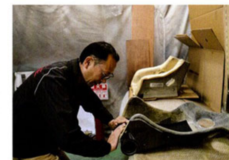
□ フルバケット表皮 縫製が完了した表皮を被せていく。同時にシートクッションも表皮を被せて組み合わせればフルバケットは完成。
