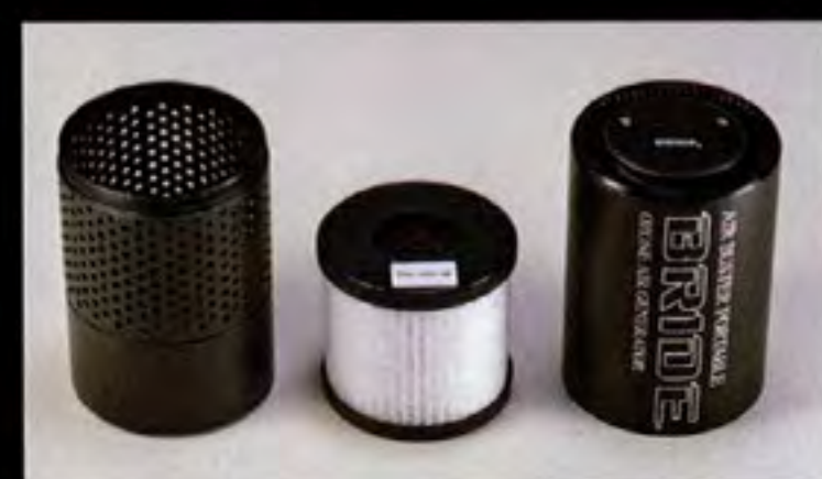
プレフィルター、HEPAフィルター、活性炭フィ ルターの三層構造になったものを使用。フィル ター交換の目安は3~6カ月で定価は3300円だ。
