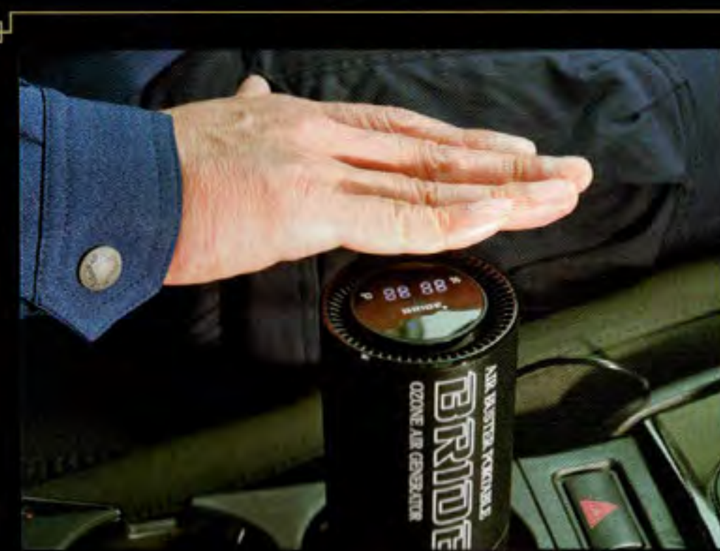
プレフィルター、HEPAフィルター、活性炭フィ ルターの三層構造になったものを使用。フィル ター交換の目安は3~6カ月で定価は3300円だ。
