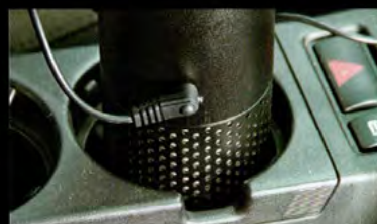
電源はUSB。本体をカップホルダーに設置する 際に干渉しないように、差し込み口はボディ中頃に 設けられている。
