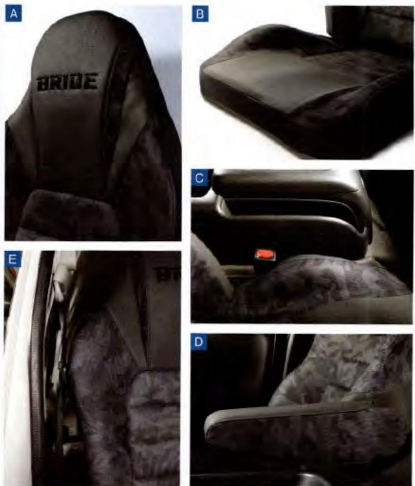
**A** バックレストの形状は腰掛けたときに背骨が自然なS字になるよう設計されている。これにより走行振動などの腰椎にかかる衝撃を受け止めながら逃がすことで、腰痛予防のアシストやドライブ時の疲労を極力軽減する **B** 座面部分は中央をわずかに盛り上げることで腿の裏をしっかり支えて快適な着座感を与えてくれる **C** ニーサポートとコンソールのクリアランスも確保し、純正シートのようにジャストフィットする **D** バックレストの左右には別売りで専用のアームレストも装着できる。価格は左右用、各9350円となる **E** 空間に余裕がないキャブオーバー型車でも干渉なく収まるのが同社製品のポイントだ
