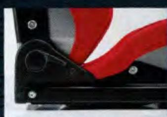
使いやすさを重視したリクライニング機構は、ガイアスⅡまでのダイヤル式からレバー式に一新。狭い車内でも操作性に優れているのはもちろん、バックラッシュ量も軽減して微妙な角度調整にも対応。
