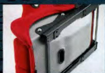
ブリッド特有のローマックスシステムは新しいガイアスⅢでも健在。また、サーキット走行で使用される際の安全性を考慮して、6点ハーネスに対応できるよう股下ベルトホールを新設している。
