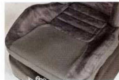
ショルダーの張り出しを抑えている分、座面に若干厚みを持たせてホールド性をカバー。ロール時の体の移動を抑える。
