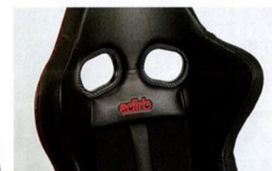
ショルダーサポートの形状も高いホールド性をもたらしている秘密のひとつ。また、レーシングハーネスおよびHANS同時装着時の身長(産高)の個人差に対応するため、大径ベルトホールとしている。
