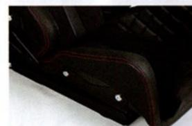
プロテインレザー™、ウルトラエード®、ヴィーガンレザー【ビガプリモ】という3つの表皮が使用されている。シート乗降時にもっともストレスがかかる座面のサイドサポート上部にはシボ加工が施されたヴィーガンレザーが用いられており、抜群の耐久性を実現しているのだ。
