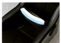
標準モデルに対してシェル側の尻部に15mm厚のウレタンフォームが貼り付けられ、尻部クッションにも15mm厚のウレタンが追加されている。クッションの追加ウレタンは抜くこともできるため、ヒップポイントを調整することが可能だ。
