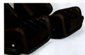
写真奥がスタンダードクッション採用の161で、手前がロークッション採用の162。こちらは脱着可能かつ、別売でも購入可能なので自分好みのポジションを構築することができる。また座面下には6点ベルト対応のベルトホールも設けられている。
