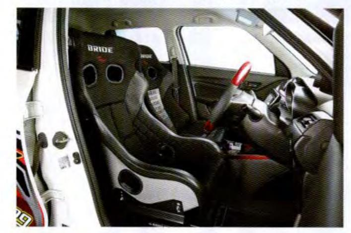
部の張り出しの大きさやS字形状のバックレストなどにより、抜群の包まれ感、疲れにくさ、ヘルメットを被ったときの後方クリアランスを誇る。ハンドルが近くなる利点もあり、レースやジムカーナ、ラリー、ダートトライアルでは定番人気となっている。ブロの評価も高い。着座位置はZETAIVより5mmから10mmほど高く、背筋が伸びるので、アイボイントも高くなるが、スイフトの場合、ヘッドクリアランスに余裕があるので、さほど気にならない。また、ピラーへの干渉やシートベルトのバックルが隠れてしまうなどという障害も避けられるし、もともと乗り降りがつらいシート形状ではあるが、そこに関しても、ほかの車種よりはラクといえる。こちらもハンドルセンターより10mmドア側にオフセット。
