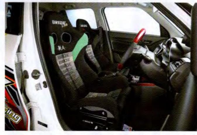
ルバケット級の剛性とホールド性を備えたリクライニング機構付きのセミバケットシート。とくに腿の支えがうれしいが、最も効いているのは肩の部分だ。ハンドルセンターより10mmドア側オフセット。ヒップボイントは純正比一約40mm。尻が痛くならないよう、座面のウレタンを厚くしているのが原因だ。シートバックはZETAIV以上にストレートなので、立てていると尻に体重が集中してしまう。なので、寝かせ気味にして、体重を分散させるほうが疲れにくく、持ち前のホールド性も得やすい。自在に細かくドラボジが調整できて、万能に近く、奮発して買ったとしても後悔はしないだろう。十分にもとが取れるセッティング幅が広いチューニングパーツだ。サイドサポートが大きい分、乗降性にはやや難あり。
