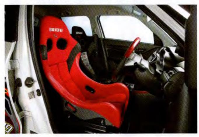
ちらもヒップポイントは純正比一約45mmで、ハンドルセンターからはドア側に10mmオフセット。バックレストが弧を描いていて、長身の人が背中を丸めて座り、アイポイントを低くすることができる形状だが、そういう体型であれば、同時に包まれ感の高さも得られるはずだ。バックレストが丸まっている分、後方クリアランスが得やすく、キャビンが狭いクルマでも有利。しかし、ヘルメットを被ると、首が前傾姿勢になりがちだったりするので、試座したうえで決め、取り付けの際も、角度など検討したほうがよい。
