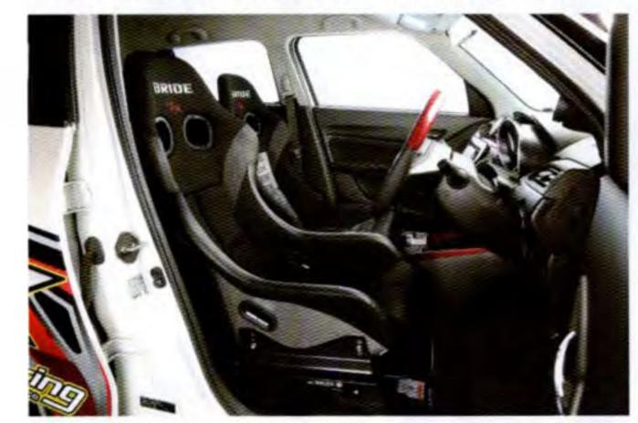
どよいローボジション。ヒップボイントは純正より約45mmダウン。ハンドルセンターよりドア側に10mmオフセットするが、違和感はほとんどない。直線的なバックレストに身体を預けて座ると、肩や腕の力を抜きやすく、リラックスした状態でのドライブが可能。もっとも、ハンドルはやや遠くなる傾向だ。ヘッドガード付きでわずかに低いヒップポイントを好むなら、同じく直線的なバックレスト形状のXERO CSを選ぶのも手。小ぶりだが、ヘッドガードも備わる。サイドサボートの高さも似ていて乗降性は同レベル。
