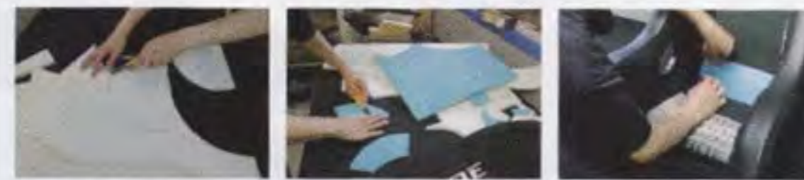
シートチューニングはBRIDEの大田直彦製作部部長が担当。ウレタンやスポンジをカットして、クッションの内側に入れて隙間を埋める
