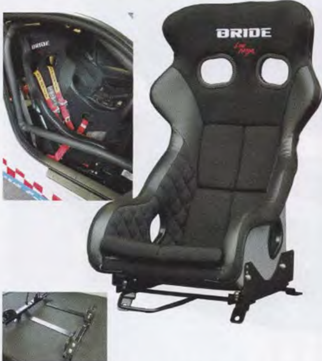
シートチューニングはBRIDEの大田直彦製作部部長が担当。ウレタンやスポンジをカットして、クッションの内側に入れて隙間を埋める
