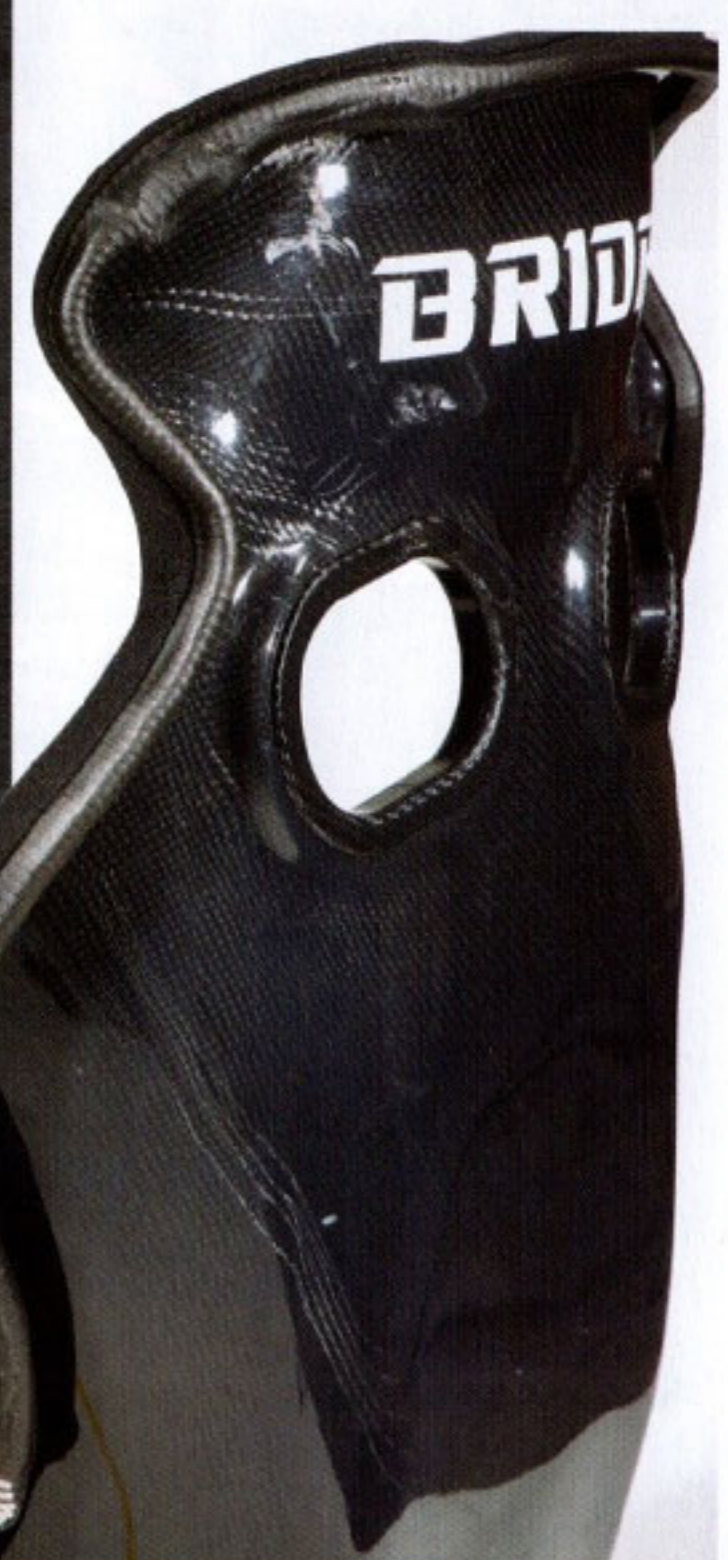
シェルのヘッドレスト背面とバックレスト左寄り背面に入った傷。割れや歪みは確認されていない
