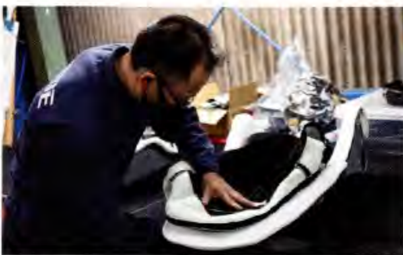
ボンドを付けたウレタンをファイバー製のバックレストに張り、その上から生地をかぶせていく。流れるような一連の作業は、まさに職人芸。
