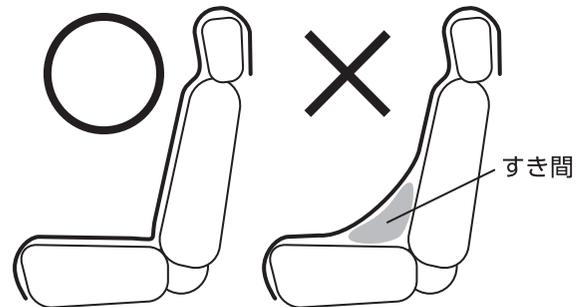
※シートカバーの間にすき間がある状態で使用すると製品が破損する恐れがあります。
