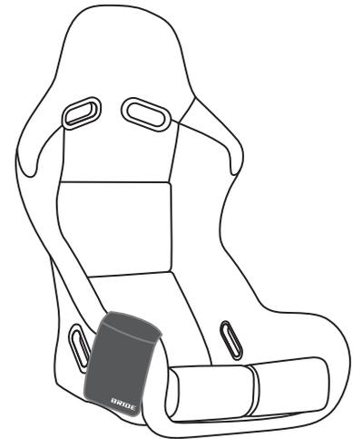
①ワンタッチテープで装着されている、シートのクッション部分を外してから本製品のポケット部分を使用したい位置へ合わせます。
